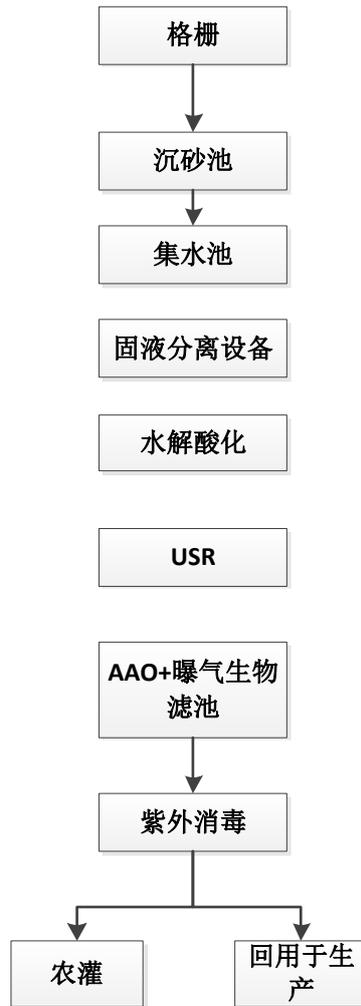
图 6.2-2 污水处理工艺流程图
